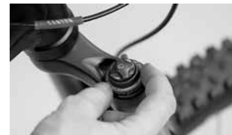
Možnosti změny nastavení tlumení stlačení
