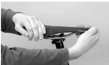
Pokuste se sedlo v rámu otočit
