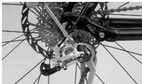
Omezte akční okruh zadního měniče prostřednictvím šroubů koncového dorazu
