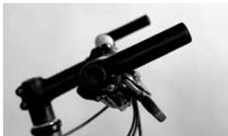
Rohy řídek poskytují přídatné možnosti držení
