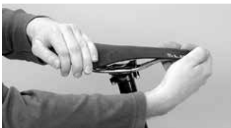
Pokuste se sedlo v rámu otočit
