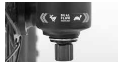
Tlumení odskoku zpomaluje roztážení pružného elementu
