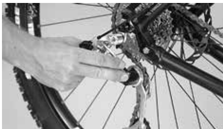
Ověřte si, že se poškozené řazení nemůže dostat do styku s paprsky
