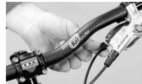
Napněte řadicí lanko dodatečně regulačním šroubem
