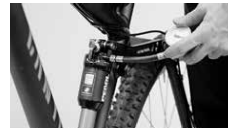
U vzduchového odpružení kontrolovat pravidelně tlak vzduchu
