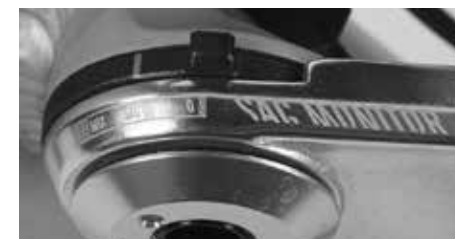
Negativní průhyb pružiny - „sag“ na pérování zadní stavby
