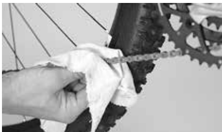
Vyčistěte řetěz od nečistoty a oleje hadrem
