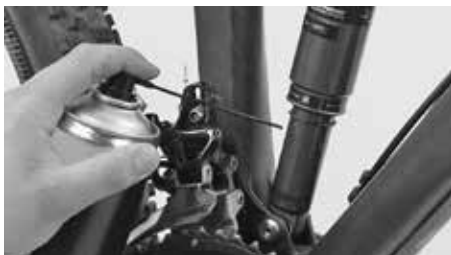
Po vyčištění nanést trochu povoleného maziva
