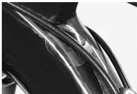
Speciální nálepky chrání karbon proti poškození
