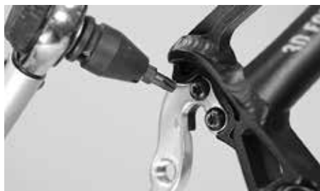
Při výměně výměnného háku měniče nesmíte v žádném případě překročit maximální utahovací moment 1,5 Nm
