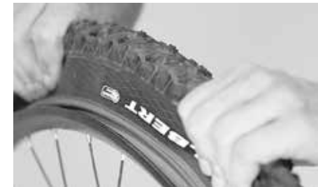
Vtlačení bezdušového pláště do středu ráfku
