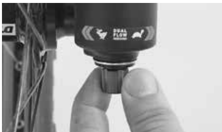
Nastavitelné tlumení odskoku
