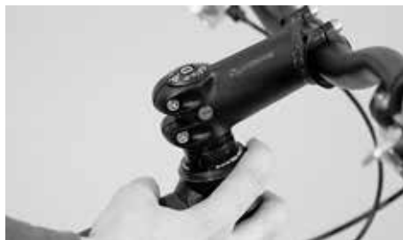
Překontrolujte vůli v hlavovém složení tak, že prsty obejmete pánev hlavového složení, přičemž posunujete Canyon se stisknutou brzdou dopředu a dozadu
