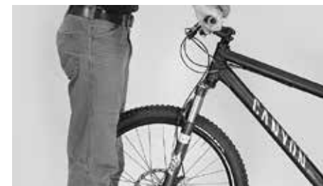
Pokuste se otočit říditka vůči přednímu kolu
