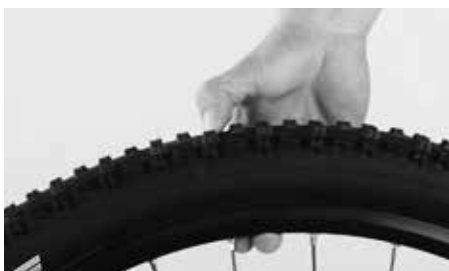
Překontrolujte tlak vzduchu v pláštích
