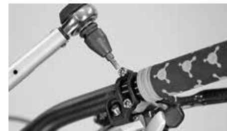
Utáhněte brzdové páky a řadicí páčky předepsaným utahovacím momentem
