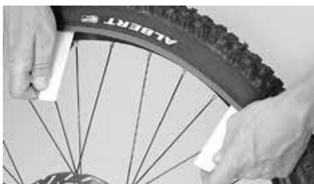
Nasazení páčidla a vypáčení boku pláště přes okraj ráfku
