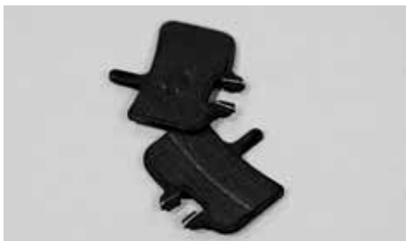
Brzdová obložení, jejichž tloušťka leží pod jedním milimetrem, se musí vyměnit za originální náhradní díly
