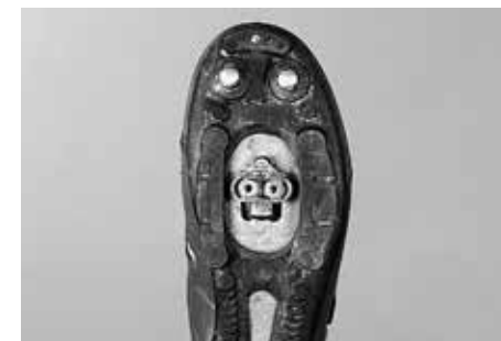
V podrážkách jsou integrovány malé přídržné destičky („cleats“)
