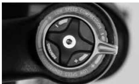
Tlumení stlačení pružiny zpomaluje stlačení pružného elementu
