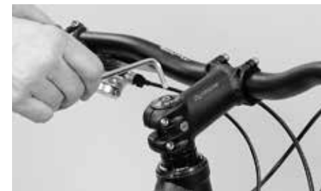
Po povolení bočních utahovacích šroubů nastavte nahoře zapuštěným seřizovacím šroubem vůli ložiska
