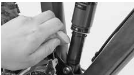
Čištění pružící vzpěry houbou a vodou
