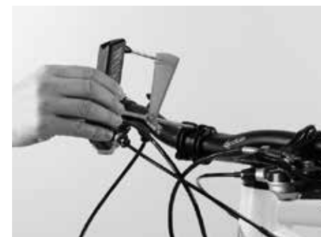
Montáž řídítek za použití momentového klíče Canyon
