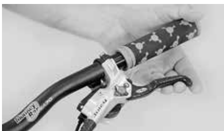
Páka brzdy se při stisknutí nesmí dotýkat řídek
