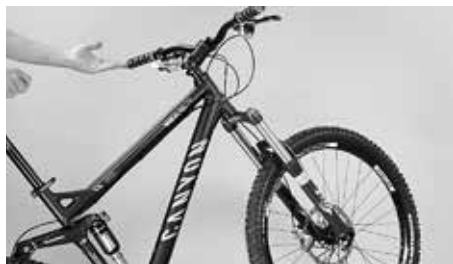
Překontrolujte lehkost chodu složení tak, že nadzvednete přední kolo a přezkoušíte, zda se nechá naprosto lehce otáčet
