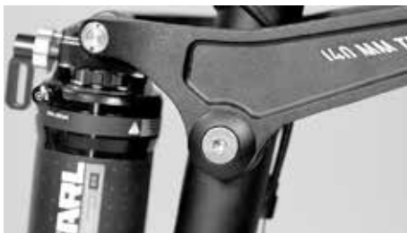
Ložiska podléhají jistému opotřebení
