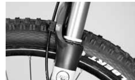
Opásejte vnitřní nohu stahovací sponou na kabely
