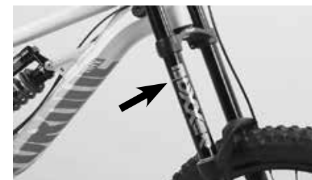
Odpružená vidlice – nastavení průhybu pružiny
