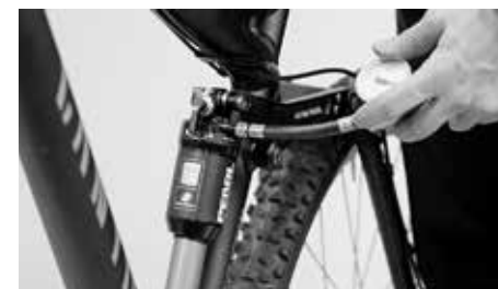
U vzduchových tlumičů se za účelem přizpůsobení mění tlak
