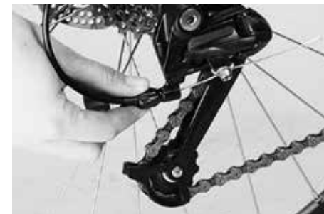
Dodatečné napnutí lanka řazení regulačním šroubem na zadním měniči
