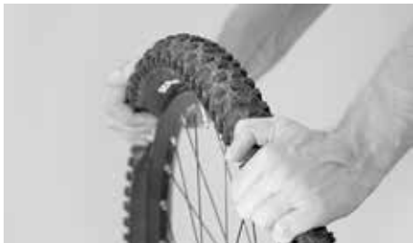
Pro jistotu stlačte plášť na obou stranách, abyste se přesvědčili, že není duše uskřípnuta
