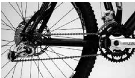
Odstavit kolo s řetězem na nejmenším pastorku a malém převodníku
