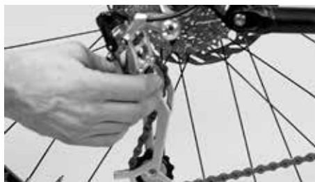
Překontrolujte, zda se může zadní měnič dostat do paprsků kola
