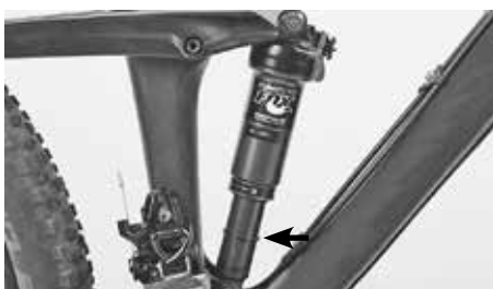
Posunutý o-kroužek na tlumiči udává využití průhybu pružiny
