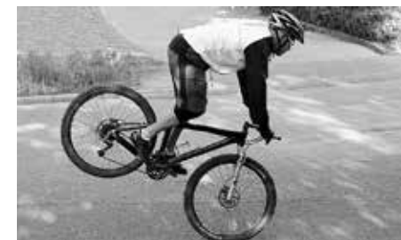
Při brzdění se přesune váha zezadu dopředu
