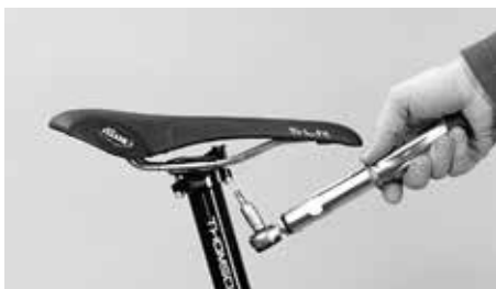
Šrouby utahujte střídavě a stejnoměrně předepsaným utahovacím momentem
