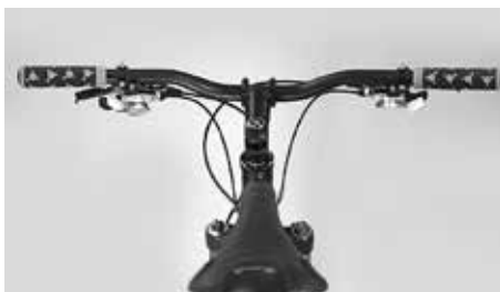
Pohlédněte přes sedlo podél horní rámové trubky, abyste si ověřili, že není rám zkřivený
