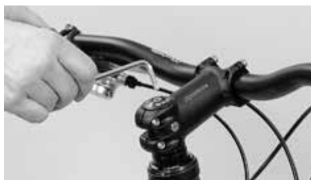
Nastavte znovu složení a představec opět pevně utáhněte
