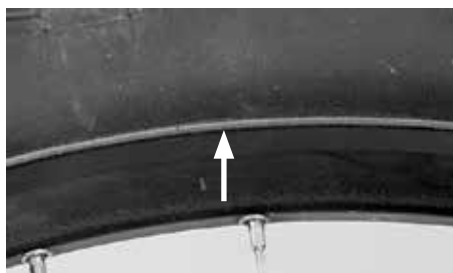
Kontrolní kruh pro usazení pláště
