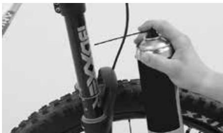
Po čištění nanést trochu povoleného maziva
