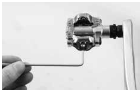
Nastavte tuhost vysmeknutí podle Vaší potřeby
