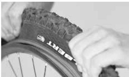
Odtlačení pláště do středu ráfku
