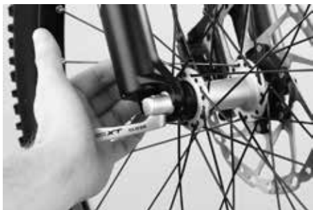
Zavření rychloupínáku palcovým valem
