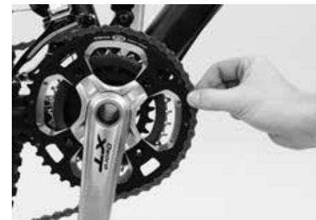
Kontrola stavu řetězu
