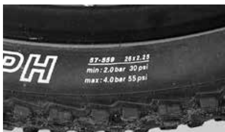
Rozměr a rozsahy tlaku vzduchu pláště
