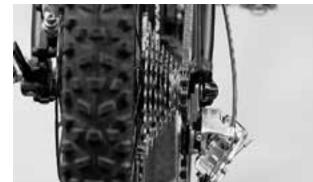
Před demontáží zadního kola přehadit na nejmenší pastorek
