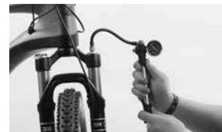
Nastavení tuhosti pružiny pomocí tlumičích hustilky
