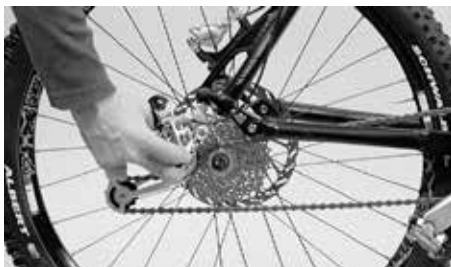
Za účelem demontáže zadního kola zatáhněte zadní měnič trochu dozadu
