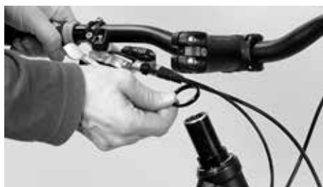
Vyjměte distanční podložky a nasuňte je opět nad představec
