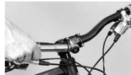
Předepsaným utahovacím momentem šrouby opět pevně utáhněte
