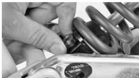
Tlumení odskoku na pružící vzpěře
