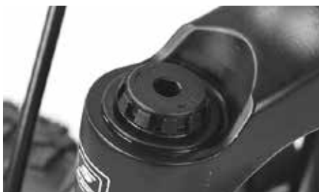
Předpětí vidlice s ocelovým perem
