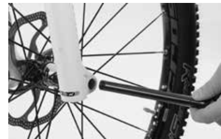
Systém výsuvných čepů kol RockShox Maxle a Maxle-Lite 15 resp. 20 mm
