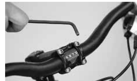
Povolte inbusový/é šroub/y na přední straně představce
