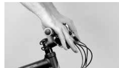
Když leží Vaše prsty na brzdových pákách, má Vaše ruka tvořit přímku s předloktím
