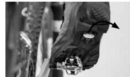
Spojení nášlapných pedálů se uvolní otočením paty směrem ven
