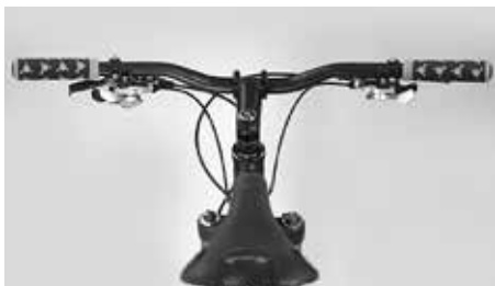
Pohlédněte přes sedlo podél horní rámové trubky, abyste si ověřili, že není zkřivený
