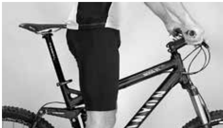
Kontrola výšky nad horní rámovou trubkou
