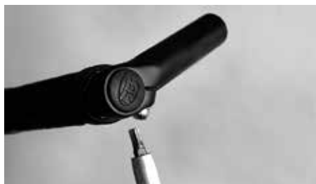
Utáhněte opět šrouby předepsaným utahovacím momentem
