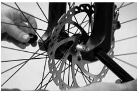
Upnutí výsuvnými čepy kol
