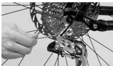
K nastavení vzdálenosti mezi klecí kladky a věncem otáčejte šroub, který se opírá o čelní stranu patky
