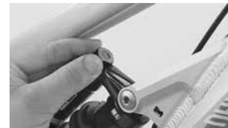
Tlumení stlačení na pružící vzpěře
