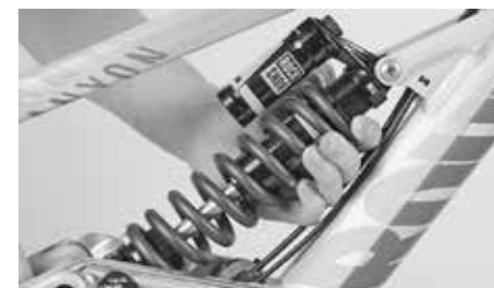
U ocelových pružin otáčejte rýhovaný stavěcí kroužek, aby se tah pružiny změnil
