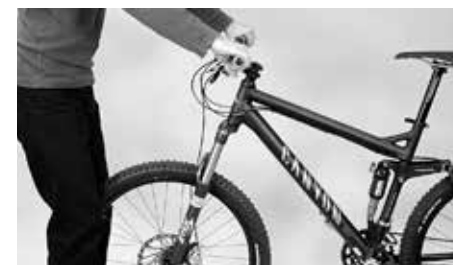
Pokuste se otočit říditka vůči přednímu kolu
