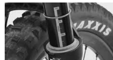
Negativní průhyb pružiny - „sag“ na odpružené vidlici
