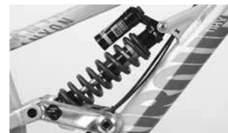
Pružící vzpěra s pružinovým prvkem z ocelové pružiny
