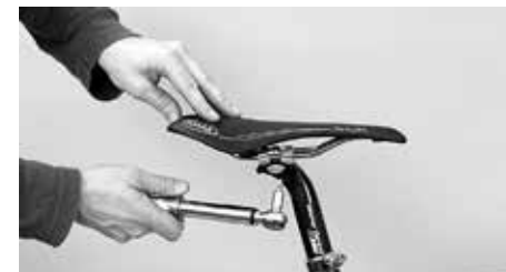
Utahujte oba šrouby střídavě a stejnoměrně, nikdy nepřekračujte maximálně přípustný utahovací moment
