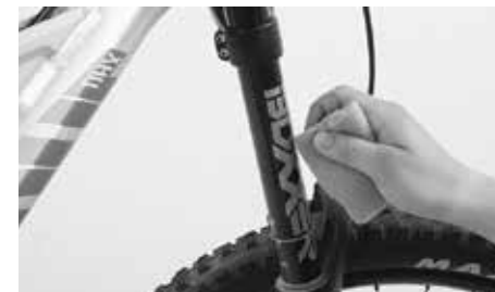
Udržujte vnitřní nohy vidlice neustále čisté
