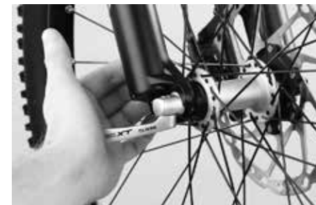
Překontrolujte, zda jsou kola stále ještě bezpečně upnuta
