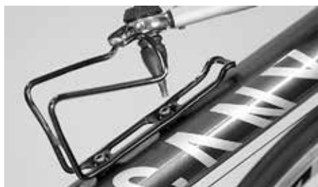
U držáku láhve dodržujte maximální utahovací moment 5 Nm
