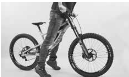
Stlačte vidlici se stisknutou přední brzdou dolů
