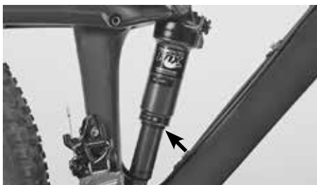
O-kroužek na tlumiči úplně nahoře
