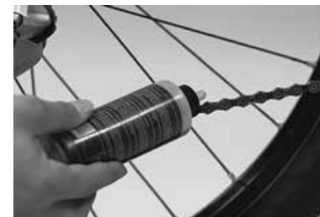
Po ukončení čištění namažte řetěz
