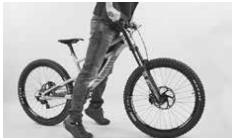
Réappuyez la fourche vers le bas en ayant actionné le frein avant
