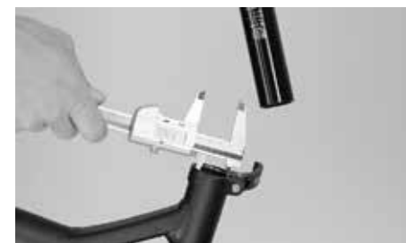
Assurez-vous que la tige de la selle soit parfaitement adaptée au cadre
