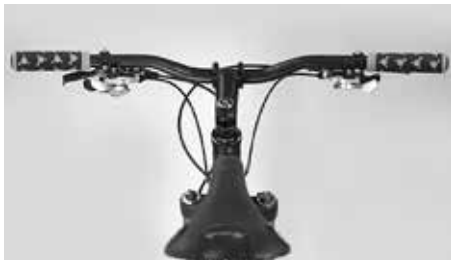
Vérifiez l'alignement de la selle par rapport au cadre en utilisant le tube supérieur comme repère
