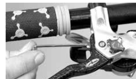
Réglage de la garde du levier de frein
