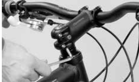
Desserrez les vis qui pincent la potence sur le pivot
