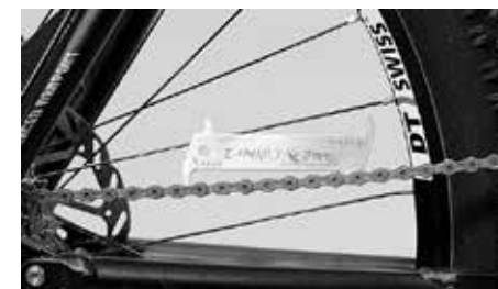
Vérification de l'état d'usure avec un outil professionnel
