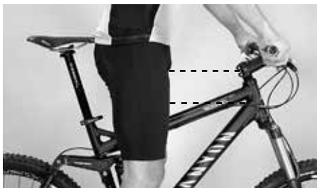
Le cadre doit offrir une liberté de mouvement suffisante au niveau de l'entrejambes
