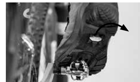
La chaussure est décrochée de la pédale en faisant pivoter le talon vers l'extérieur
