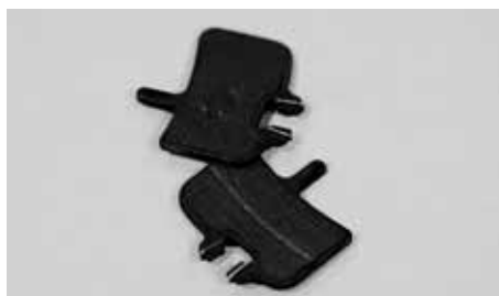
Les garnitures de frein dont l'épaisseur est inférieure à un millimètre doivent être remplacées par des pièces de rechange d'origine
