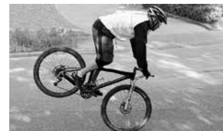
Lors du freinage, le poids du cycliste se déplace de l'arrière vers l'avant
