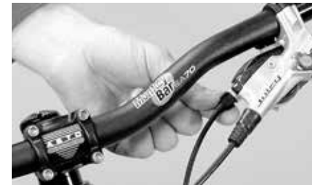
Rattrapez la tension du câble de dérailleur sur le barillet de réglage
