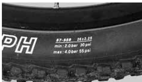
Plage de pression indiquée sur le flanc du pneu
