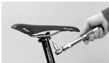
Resserrez les vis, en alternance et progressivement, au couple de serrage prescrit
