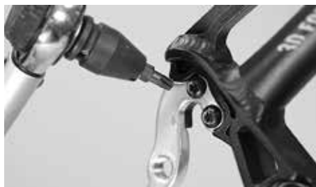
Lors du remplacement de la patte de dérailleur, ne dépassez en aucun cas le couple de serrage maximum de 1,5 Nm
