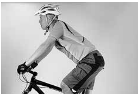
L'écart entre les poignées du cintre et la selle influe sur l'inclinaison du dos
