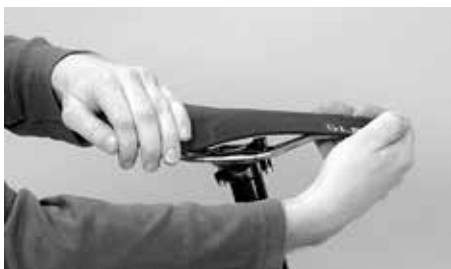
Essayez de faire pivoter la selle autour de l'axe de la tige
