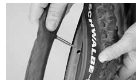
Introduction de la valve dans le trou de la jante
