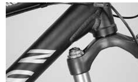
Le té de la fourche doit pouvoir pivoter sans toucher le cadre
