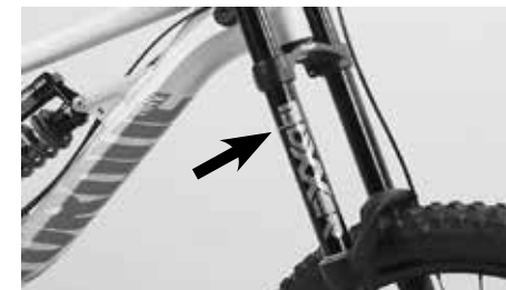
Fourche suspendue - réglage du débattement
