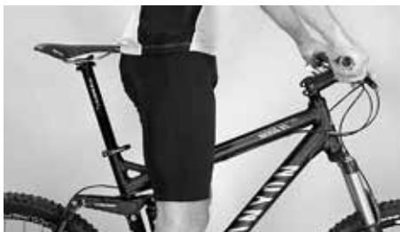
Vérifier l'écart de l'entrejambes par rapport au tube supérieur
