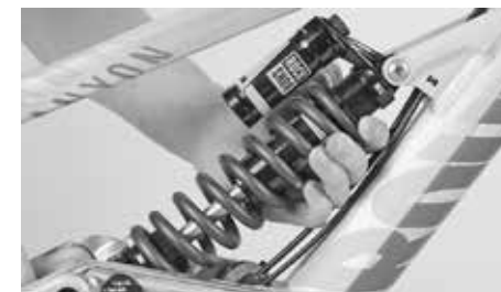
Sur les amortisseurs à ressort, la précontrainte du ressort est modifiée en tournant la bague de réglage moletée
