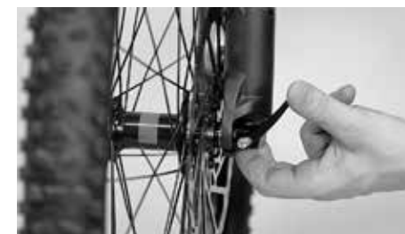
Veillez au bon positionnement de l'attache rapide
