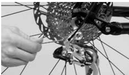
Pour régler l'écart entre la chape de dérailleur arrière et la denture, tournez la vis qui s'appuie sur le côté de la patte de fixation du dérailleur
