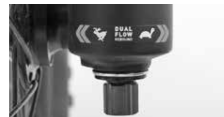
L'amortissement du rebond ralentit la détente
