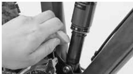
Nettoyage de l'amortisseur avec une éponge et de l'eau
