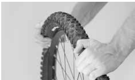
Malaxez le pneu des deux côtés pour vous assurer que la chambre à air n'est pas coincée entre le pneu et la jante
