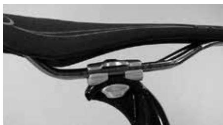
Positionnez la selle de sorte que ses rails soient fixés à l'intérieur de la section graduée
