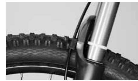
Le déplacement du rilsan sur le plongeur vous permet de déterminer le débattement utilisé
