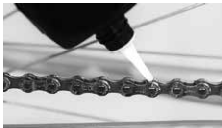
Appliquez sur les maillons dégrasés du lubrifiant pour chaîne
