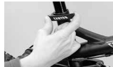
Pour régler la hauteur de la selle, vous devez desserrer le levier du collier de serrage
