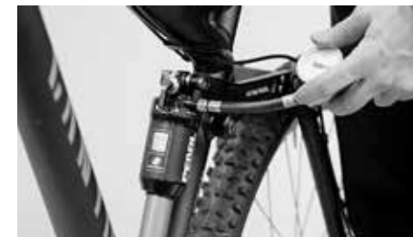
Sur les amortisseurs à air, le réglage s'effectue en variant la pression pneumatique
