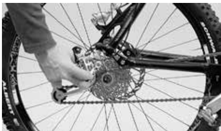
Pour démonter la roue arrière, tirez le dérailleur légèrement vers l'arrière
