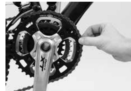
Vérification de l'état d'usure de la chaîne
