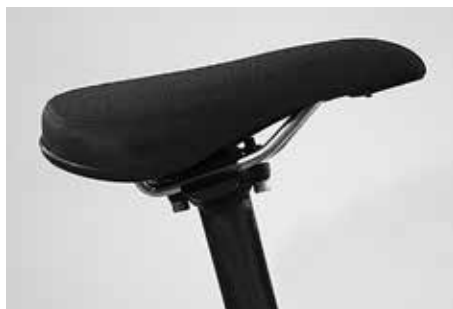
Sur les vélos de freeride etc., la selle est en général inclinée vers l'arrière
