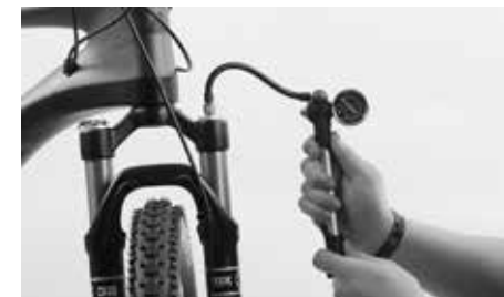
Réglage de la dureté de la suspension avec une pompe pour amortisseur
