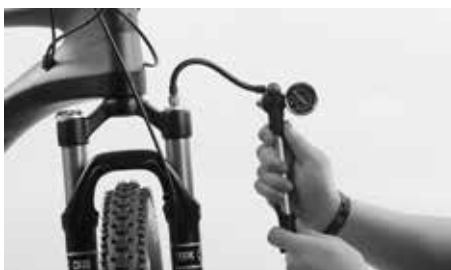
En cas des suspensions pneumatiques contrôler régulièrement la pression
