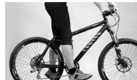
La jambe doit être complètement tendue quand la pédale se trouve dans la position la plus basse et que le talon du pied repose à plat sur celle-ci
