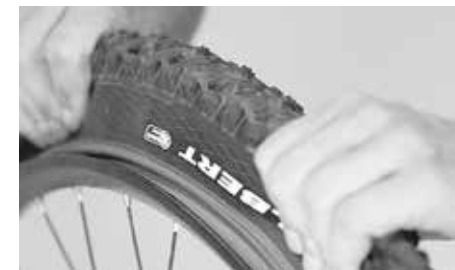
Pression sur le pneu Tubeless vers le centre de la jante
