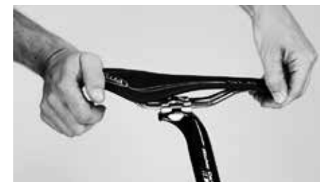
Vérifiez après le serrage si la selle bascule encore
