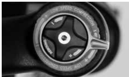
L'amortissement de la compression ralentit la compression
