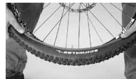
Introduction du pneu dans la jante
