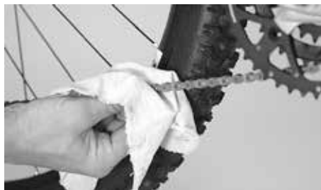
Nettoyez la chaîne de ses impuretés et des résidus de graisse à l'aide d'un chiffon
