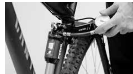
En cas des suspensions pneumatiques contrôler régulièrement la pression
