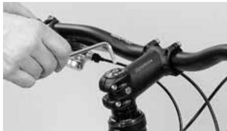
Réajustez le réglage du jeu de direction, puis resserrez la potence
