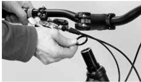
Enlevez les entretoises du pivot, pour les replacer ensuite au-dessus ou au-dessous de la potence
