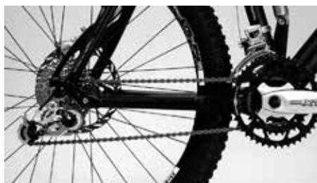
Chaîne sur petit pignon et petit plateau pour le stockage du vélo
