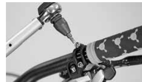
Serrez les commandes de frein et de dérailleur au couple de serrage prescrit
