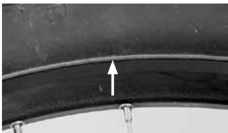
Ligne témoin sur un flanc du pneu
