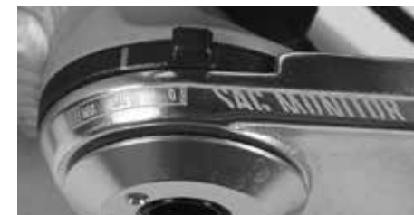
Le débattement négatif – « sag » de la suspension arrière
