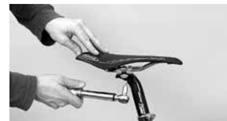
Resserrez les deux vis en alternance et progressivement, sans jamais dépasser le couple de serrage maximum autorisé
