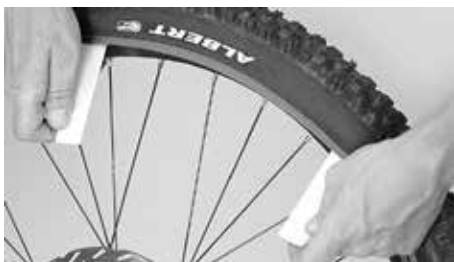
Introduction du démonte-pneu sous le talon du pneu et basculement du talon par dessus le rebord de jante
