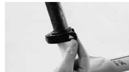
Ne serrez pas l'attache rapide trop fermement
