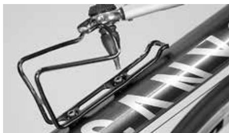
Respectez le couple de serrage maximum de 5 Nm pour la fixation du porte-bidon
