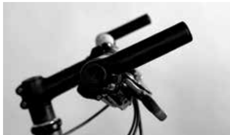
Les embouts de cintre permettent de varier la position des mains
