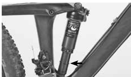
Le déplacement du joint torique indique le débattement utilisé
