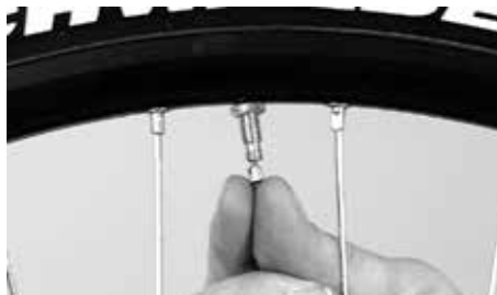
Sur les valves Presta ou Schwalbe, l'écrou moleté de la valve doit être desserré pour permettre le gonflage
