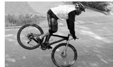
Freinage à fond sur la roue avant : risque de culbute !
