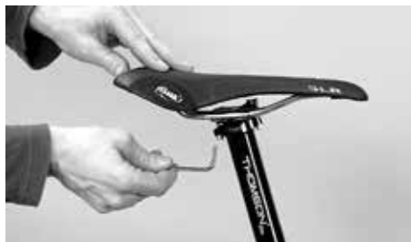
Desserrez les deux vis de 2 à 3 tours maximum
