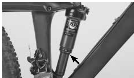
Joint torique, tout en haut sur le plongeur de l'amortisseur
