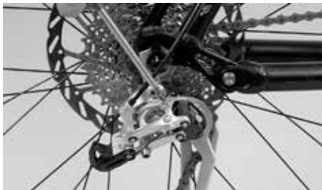
Limitez le débattement du dérailleur arrière à l'aide des vis de butée
