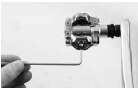
Réglez le seuil de déclenchement des pédales en fonction de vos besoins
