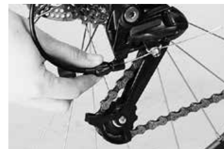
Ajustage de la tension du câble de changement de vitesse sur le barillet de tension du dérailleur arrière
