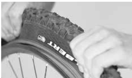
Pression sur le pneu vers le centre de la jante
