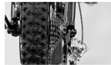
Passez sur le petit pignon avant de procéder au démontage de la roue arrière
